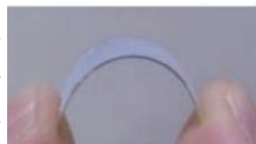
図 1. 有機基材上に直接形成された圧電薄膜 (フレキシブルデバイスへの応用)
