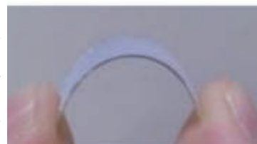
図 1. 有機基材上に直接形成された圧電薄膜（フレキシブルデバイスへの応用）
