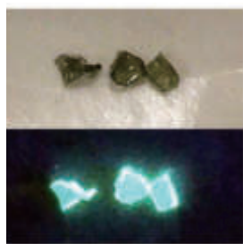
図1 Euイオンをドープした酸窒化物ガラス（上）と紫外光照射時の発光の様子（下）
