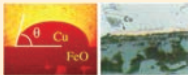
図1 固相FeOと熔融Cu間の接触角測定(実験)と、銅と酸化鉄間に生じた銅濃縮相(実プロセス)
