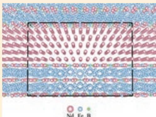
図 1：Nd-Fe-B 焼結磁石の材料組織界面（主相は \text{Nd}_2\text{Fe}_{14}\text{B} 、副相は dhcp Nd）。この様に原子スケールで平坦な界面が走査型透過電子顕微鏡による観測によっても得られている。
