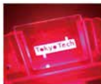
図2. アモルファスZn-Si-O（ZSO）の新たな電荷輸送層を用いるペロブスカイトELの素子構造および発光写真。右図はプラスチック基板上に作製されたペロブスカイトEL。
