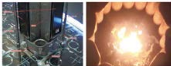
図3 原子炉炉心構造物とコールドクレーンシブルによるデブリ模擬溶融試験
