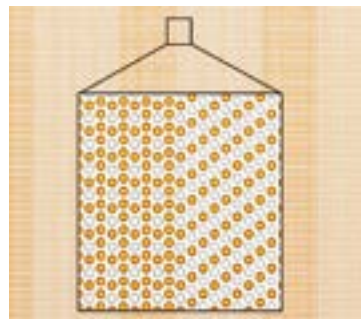
図3：Ti-Al 合金の結晶粒内部に見られる \alpha_2/\gamma ラメラ組織の理想的な原子配置。
