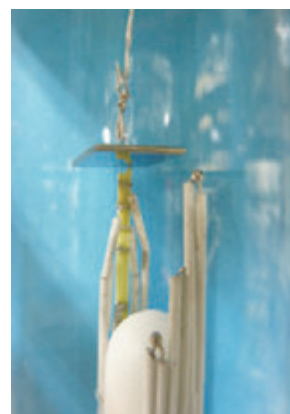
図2 雰囲気制御型高温酸化皮膜表面酸素ポテンシャル測定装置。高温ガス環境下における金属材料表面に形成する酸化皮膜表面の酸素の状態を観測する装置。酸化現象の本質に迫ります。
