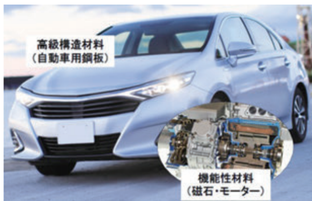
図2 ハイブリッドカーに使用される鉄鋼・鉄基合金材料
