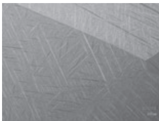
図1 生体用β型Ti-Zr-Nb合金中に成長したウイドマンステッテン組織。幾何学的な組織が美しい
