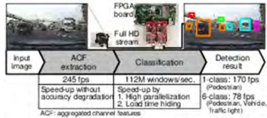
図 2. BDT による物体検出 HW
