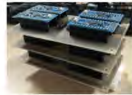
図4: 小型マイコンArduinoを用いた並列分散ニューラルネットワーク
