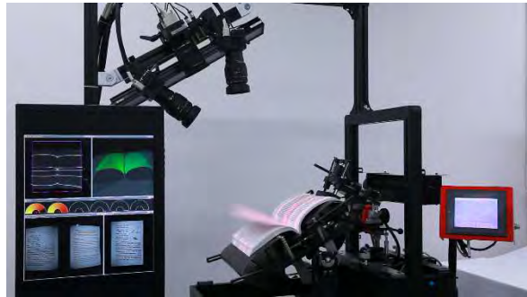
図 2 高速書籍電子化システム
