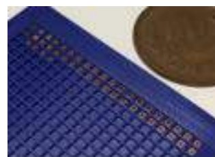
図2：65nm CMOS プロセスの試作チップ
