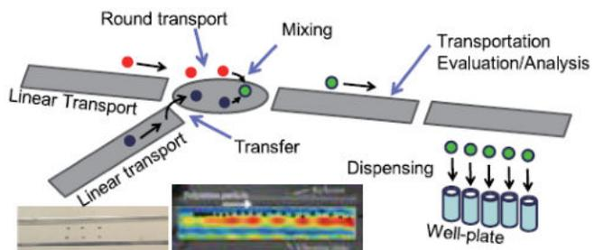
直径 1mm 程度の液滴の搬送や混合、滴下が可能になっている。さらに高度な操作や分析の実現をめざしている。
