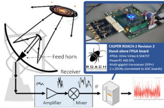
電波望遠鏡用信号処理装置の概要
