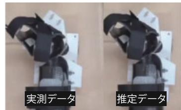
図2. 手首のロボットスーツを実測（左）および推定（右）した筋電信号で動かした例
