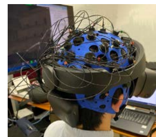
図4. 脳波とVRヘッドマウントディスプレイとの同時計測
