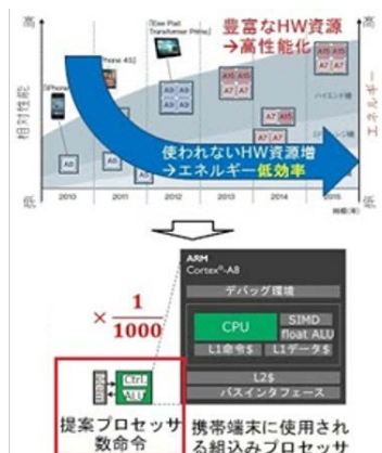
図1：近年の組み込みプロセッサの傾向(上)と本研究室で開発している超小型プロセッサ(下)
