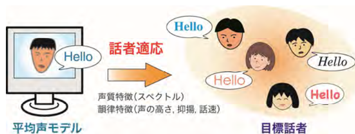
図1 平均声からの任意話者音声の合成:少量の目標話者の音声を基にその人の喋りを合成する
