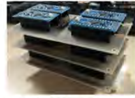
図4:小型マイコンArduinoを用いた並列分散ニューラルネットワーク
