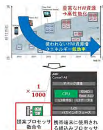
図1：近年の組み込みプロセッサの傾向(上)と本研究室で開発している超小型プロセッサ(下)
