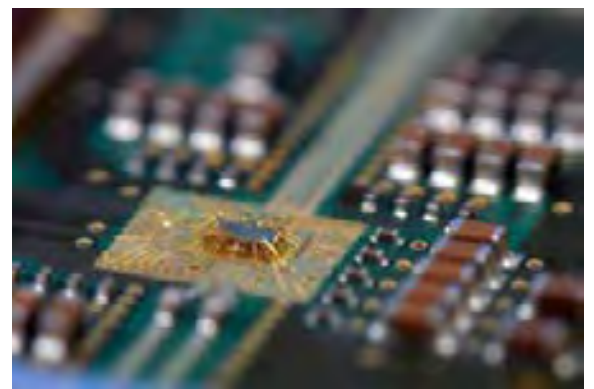
図3. 圧電共振器を用いたシンセサイザ回路
