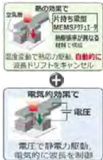
図4 波長温度無依存化と波長可変動作の原理
