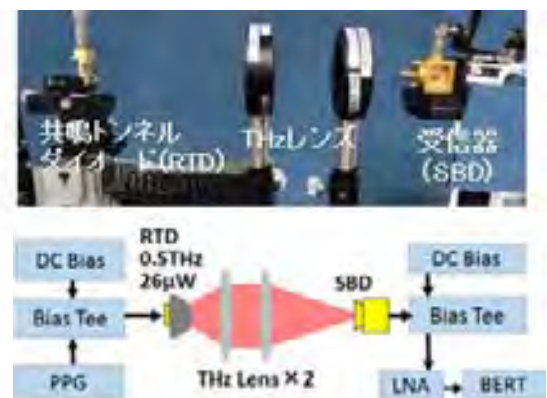
図3 共鳴トンネルダイオード送信器を用いた高速テラヘルツ無線通信系。
