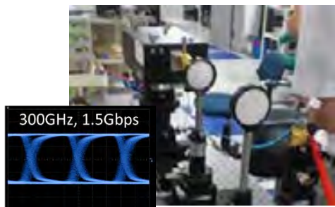
図3 HEMT受信器を用いた無線通信測定系
