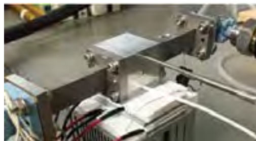
図1 導波管貫通法の温度可変測定系
