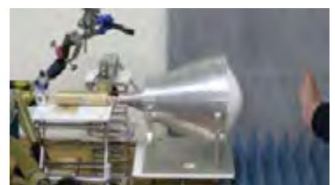
図8 60GHzミリ波の掌へのばく露実験
