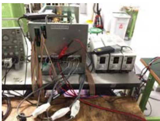
インダクタの小型・軽量化が実現可能な補助変換器を用いた双方向チョップの外観図
