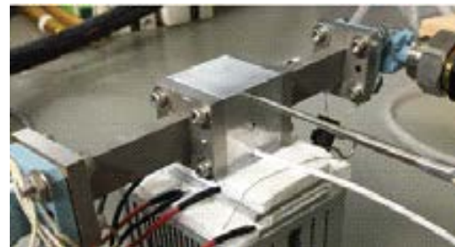
図1 導波管貫通法の温度可変測定系
