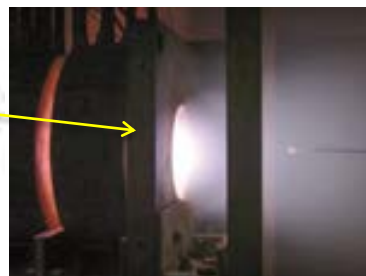
磁気ノズルから噴出される超音速膨張アークジェット
