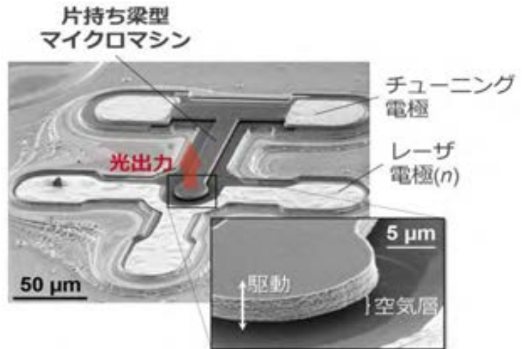
図5 マイクロマシン面発光レーザ
