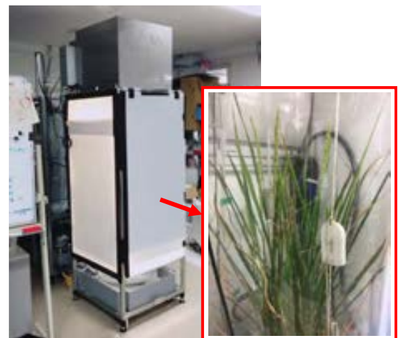
図4. 完全密閉型稲育成装置 SRP-450
