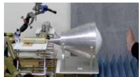
図8 60GHzミリ波の掌へのばく露実験
