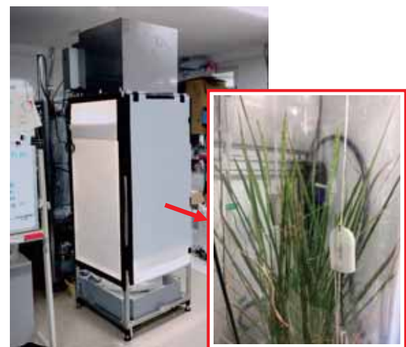
図4. 完全密閉型稲育成装置 SRP-450
