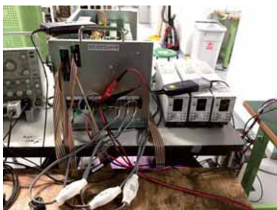
インダクタの小型・軽量化が実現可能な 補助変換器を用いた双方向チョップパの外観図
