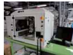
CZTSSe系膜作製用 超音波スプレー塗布装置
