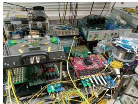
図6 多入出力光スイッチングシステム測定系写真
