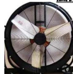
直径1mのブレードを取付けた試作機
