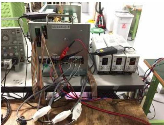
インダクタの小型・軽量化が実現可能な補助変換器を用いた双方向チョップパの外観図
