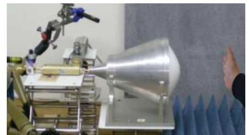
図8 60GHzミリ波の掌へのばく露実験
