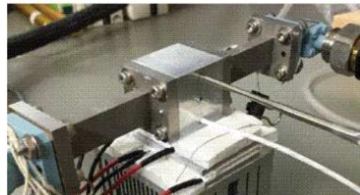
図1 導波管貫通法の温度可変測定系
