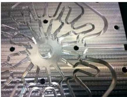
図3 円形導波管TE<sub>01</sub>モード変換器の内部
