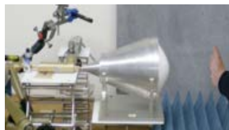
図8 60GHzミリ波の掌へのばく露実験
