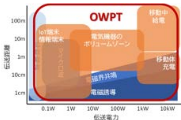
図2 光無線給電は小型軽量・長距離・大電力のため, 様々な機器・場面への利用が期待される。
