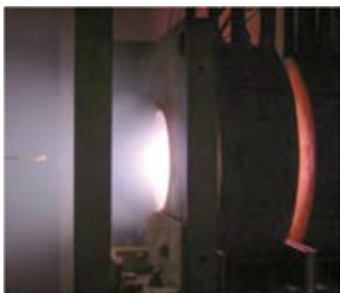
核融合炉周辺を模擬した開放端磁場のアークジェットプラズマ
