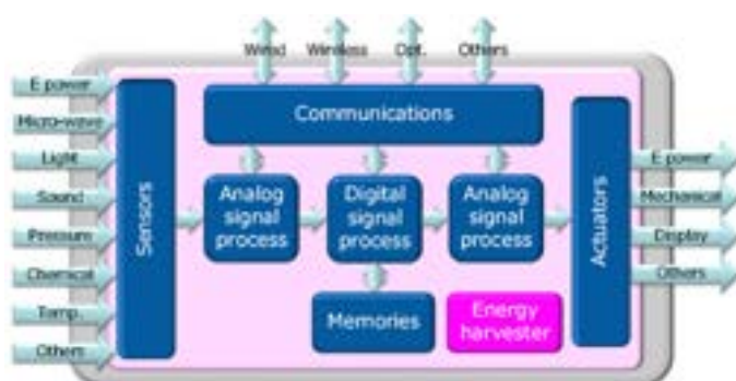
図：知的システムデバイスの信号処理フローと発電システムのブロック図。
