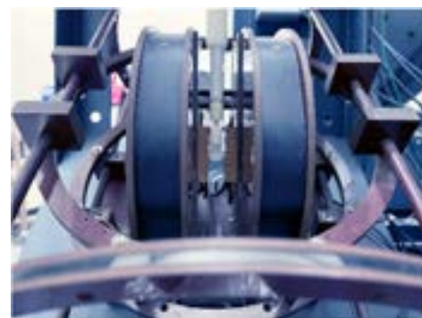
軟磁性材料の評価に用いる超低磁場・ヘルムホルツコイル・試料振動型磁力計
