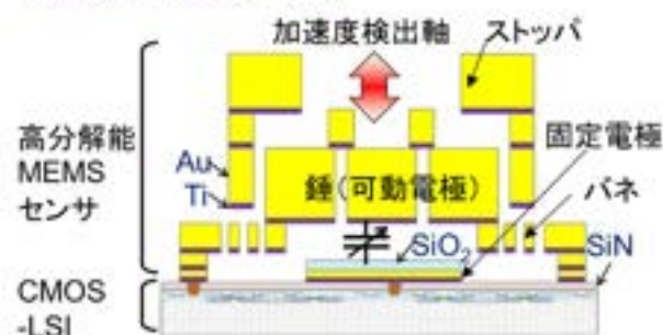
CMOS-MEMS慣性センサの断面構造
