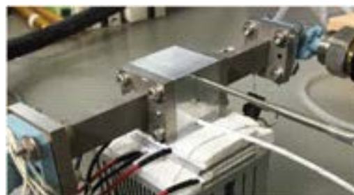
図1 導波管貫通法の温度可変測定系
