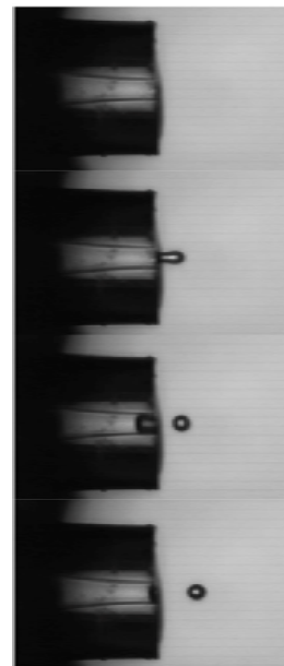
左:微小な液滴に細胞やナノ粒子を包含させてプラズマ中に射出して分析
