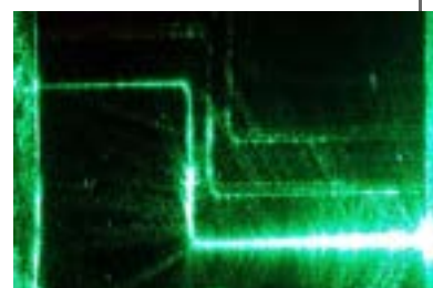
NV-ダイヤモンド集積光回路
