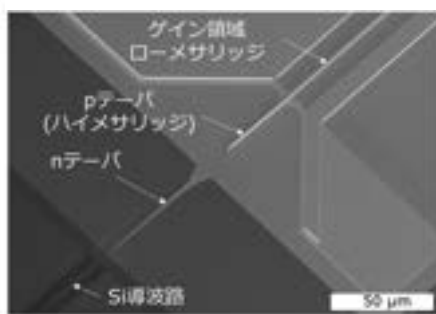
III-V/InP ハイブリッド光集積回路
