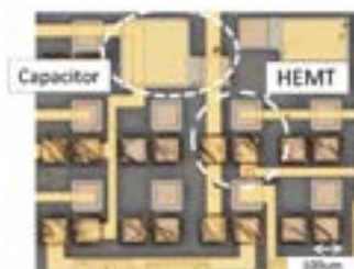
図7 GaN HEMTによるマルチレベルインバータ集積回路
