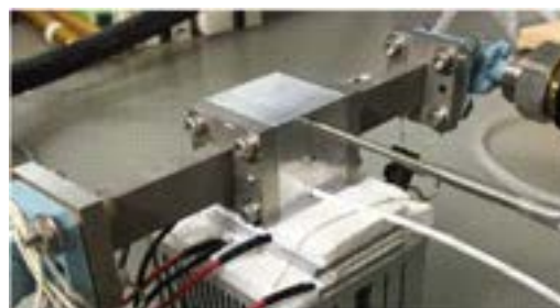
図1 導波管貫通法の温度可変測定系
