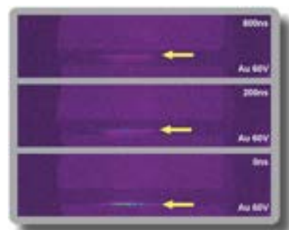
図1. 時間分解顕微SHG測定で観測される、デバイス中におけるキャリアの流れ。
