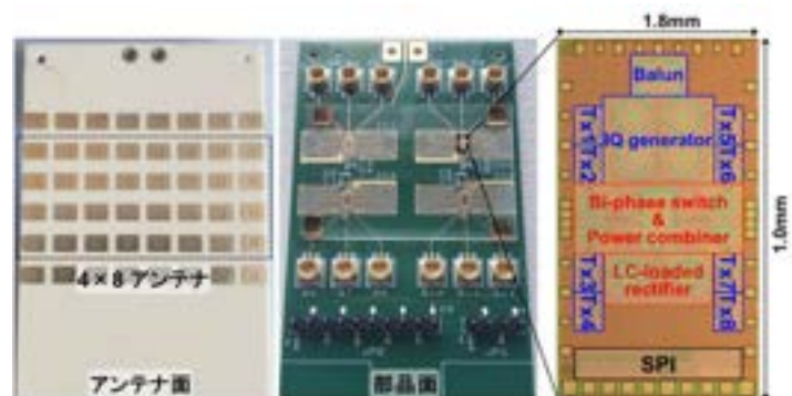
図5. 作成した無線電力伝送型5G無線機と送受信無線IC
