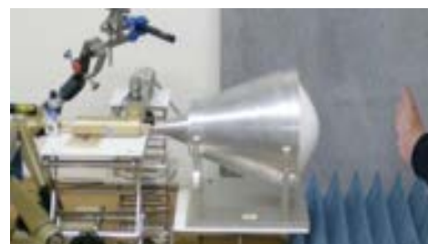
図8 60GHzミリ波の掌へのばく露実験
