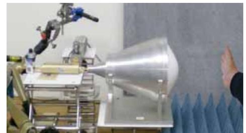
図8 60GHzミリ波の掌へのぼく露実験
