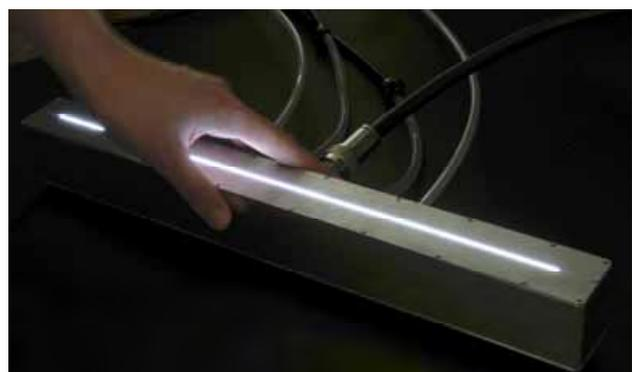
表面処理用に開発した、リニア型プラズマ装置
