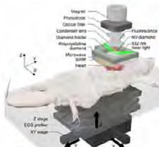
ダイヤモンド量子センサによるラットの心磁計測
