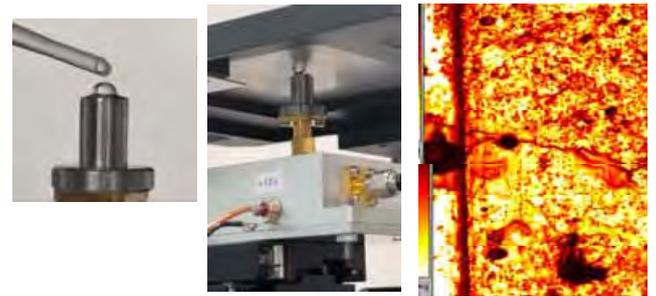
超音波顕微鏡スキャンと鉱物の音響インピーダンス映像
