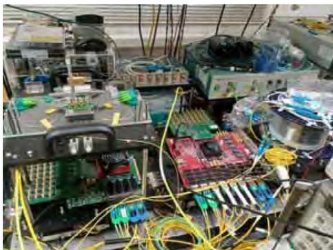
図3 光スイッチングシステム測定系写真
