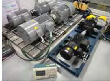
各種モータ(誘導電動機, 同期電動機)
