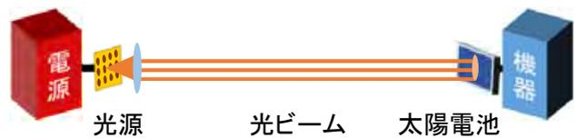
図1 ビーム光源と太陽電池による光無線給電
