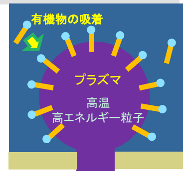
処理水中に多数のプラズマが多並に発生している様子。高速分解が可能です。
