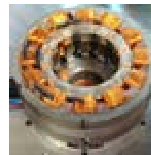
試作した固定子
