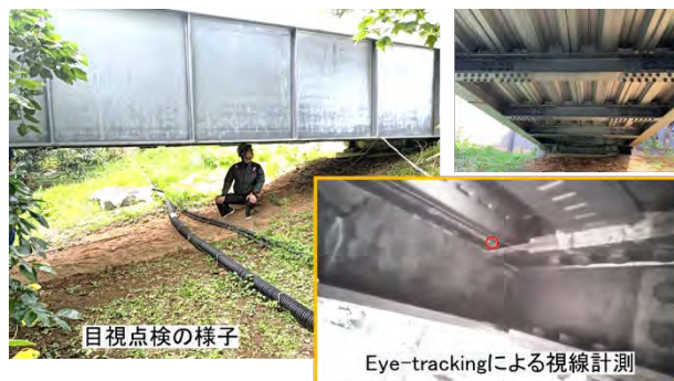
図-5 多数の被験者を対象とした目視点検実験
