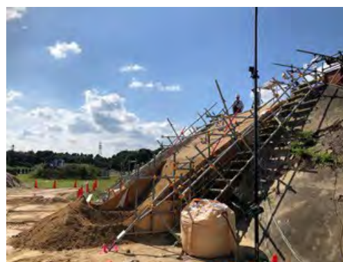
斜面崩壊予測に関する大型模型試験
