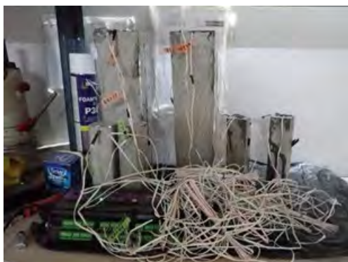
写真-1 帰国日にセットアップが終わった モルタル試験体
