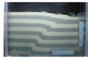
液状化対策、基礎の断層変位による变形挙動の模型実験
