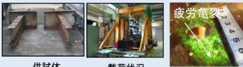
交通荷重や地震により発生する疲労き裂や破断の原因究明、発生の制御を目的として、実験および解析的な研究を進めています。
