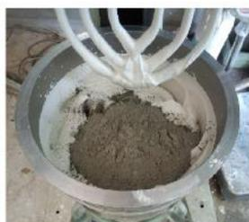
セメント改良土の作製、強度を測る実験の様子
