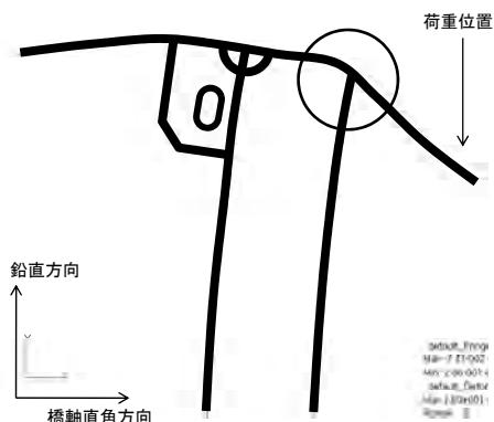
図 9 鋼床版デッキプレートに生ずる折れ角
