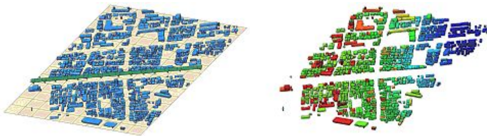
計算機上に構築した仮想現実都市とその地震被害推定の例
