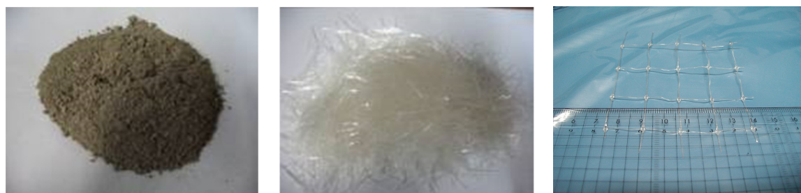
図-1 使用材料（左から、エコセメント、ペット繊維、ポリプロピレンメッシュ）
