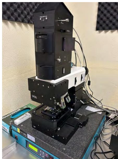
写真-2 分析装置の一例(ラマン顕微鏡)
