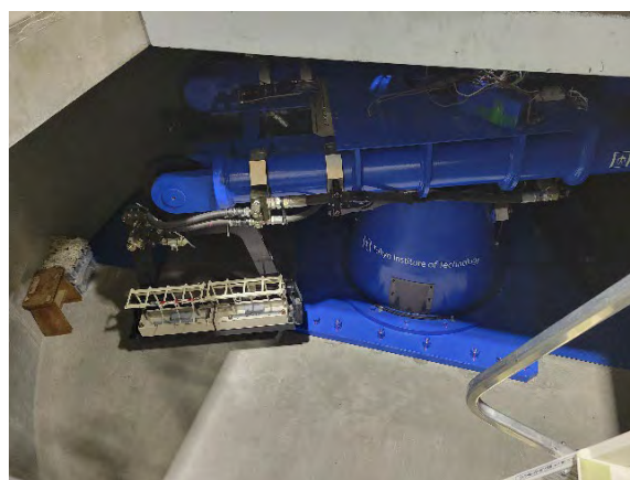
西6号館 B階土質実験室 遠心加速器
