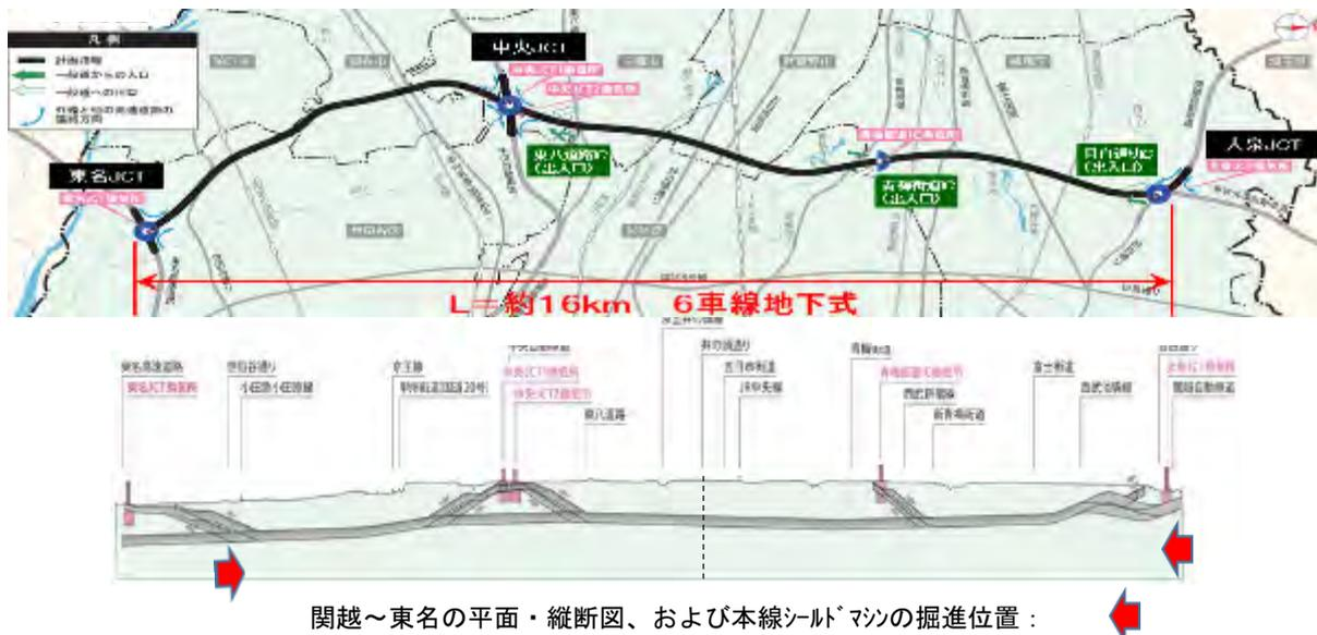
関越～東名の平面・縦断図、および本線ソルトマシンの掘進位置：
