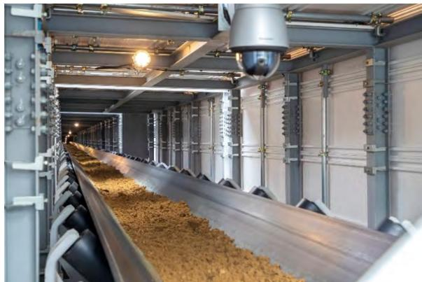
ベルトコンベヤによる土砂運搬状況
