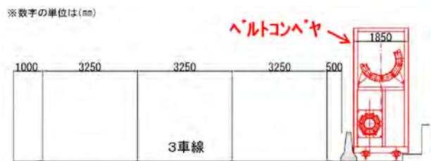
長距離曲走コンベア設置断面図
