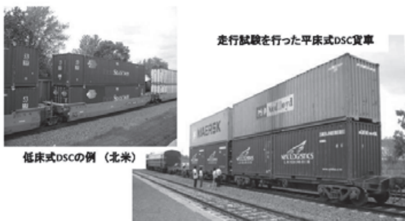
写真-1 走行安定性実証試験に使用した平床式 DSC 貨車
