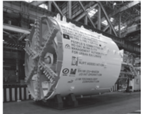
写真-4 採用されたシールドマシン
