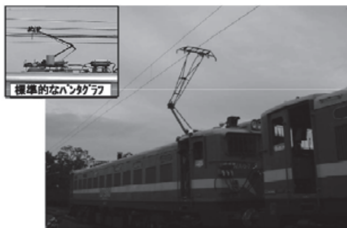
写真-2 実証試験に使用した高揚程パンタグラフ
