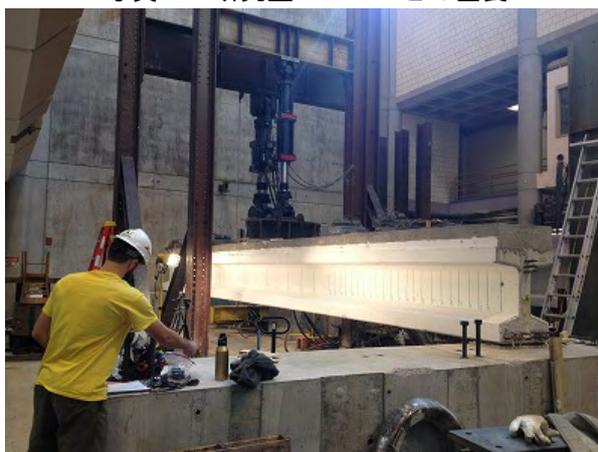
写真 6 実験室での載荷実験
