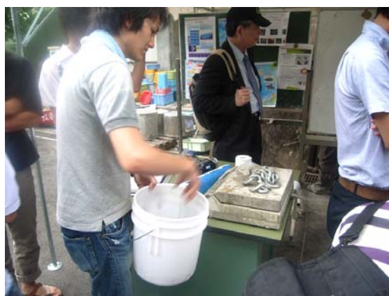
図 8 積載荷重の計測
