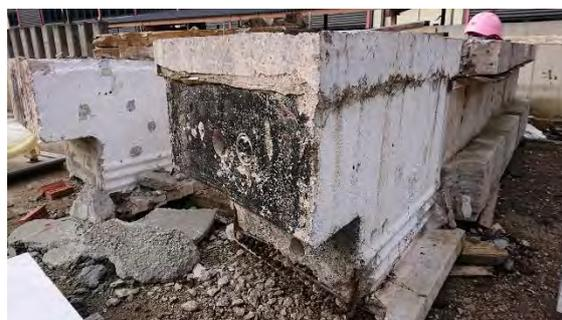
写真2 実供用された橋桁の試験体
