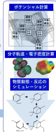
図 4. 水処理における汚染物質反応経路の理論計算
