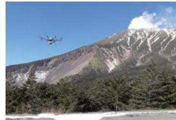
図1. 御嶽山平成26年噴火の際には、急速、ドローンに火山ガス分析装置を搭載し、人間の手では不可能な、危険な火口でのガス観測に成功しました。
