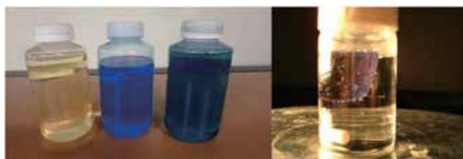
左: 水中に分散した有機半導体のp-n接合体のナノ粒子。そのままスプレーで壁などに塗布できる。このナノ粒子は流体デバイスでキログラム単位の合成も容易であり、ベンチャー企業に技術移転して、社会実装に向かっている。
