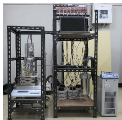
図1 MgO/H 2 O化学蓄熱(左)開発したディスク型高伝熱性化学蓄熱材、(右)化学蓄熱実証試験システム
