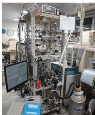
図1. 大気試料中 $\text{N}_2\text{O}$ 濃度・安定同位体比分析に用いる自作の自動前処理装置
