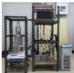
図1 MgO/H 2 O化学蓄熱(左)開発したディスク型高温熱性化学蓄熱材、(右)化学蓄熱実証試験システム
