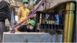
鉄筋コンクリートはりの破壊実験
