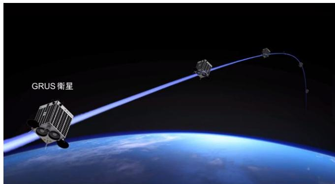
図5. 多数の超小型衛星からなる全地球観測網の構築。Axelspace社の第2の事業AxelGlobeでは、グリースGRUS衛星(図6、④)20~30機を600km上空の軌道上に数珠つなぎ状に配置することにより、地球全体のスキャンを可能にする計画であるが、まずは10機で地球の任意の地点(anywhere)を毎日撮影できる体制を整える。気象衛星「ひまわり」(35,800km上空)などに比べると高度が低く、高分解能かつ立体的に優れた画像を得ることができる;撮影幅は約55km。すでに5機を投入済みで、地表全体を2~3日に1回撮影することが可能になっているが、今後2023年までに、残りの5機を追加し「世界どこでも1日に1回撮影可能」な体制を構築する。GRUS衛星の大きさ: 60×60×80cm、重量: 100kg、従来の衛星で同性能のものは1.5トン。AxelGlobeは農業・海洋監視・局地気象予報・都市計画・工事進捗管理・公害や違法伐採の監視など多方面での活用が期待される(図7~12)。
