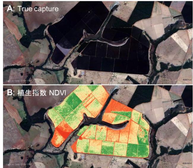
図 8. ブラジルのさとうきび畠。(A)通常の RGB カラー画像、(B)人の目には見えない近赤外線 NIR を用いた解析によって「植生指数」(NDVI = Normalized difference vegetation index)を算出した例；さとうきびの生育具合が色の違いで表示されている。
