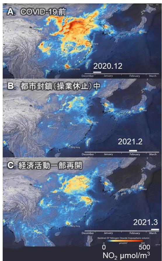
図 12. 東アジアからの二酸化窒素(NO<sub>2</sub>)の放出状況。中国では、生産活動を反映して、コロナ禍の前(A)、最中(B)、及び回復期(C)で大きな変化がみられる。このようなデータを継続的に公開すれば、公害に対する国際的な圧力となり、SDGs の達成が早まるだろう。画像は Copernicus Sentinel-5P satellite によって取
