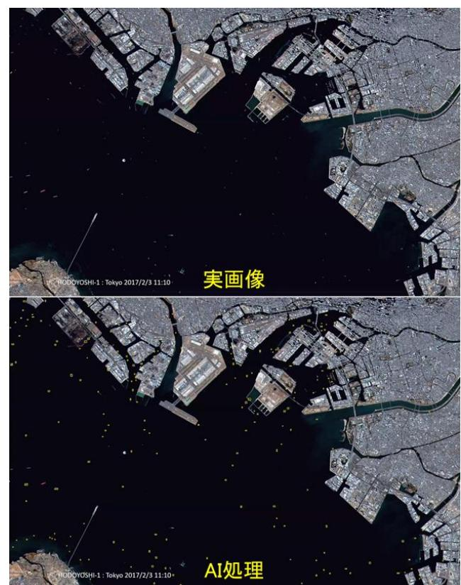
図 9. 東京湾周辺の都市・港解析。都市部の衛星写真は膨大な情報を含むゆえ、人の目による解析では追い付かない。そこで、人工知能 AI を駆使した被覆分類によって、建物・道路・港などを区別する必要がある。(上)実際の画像、(下)AI 处理によって船を検出した例。
