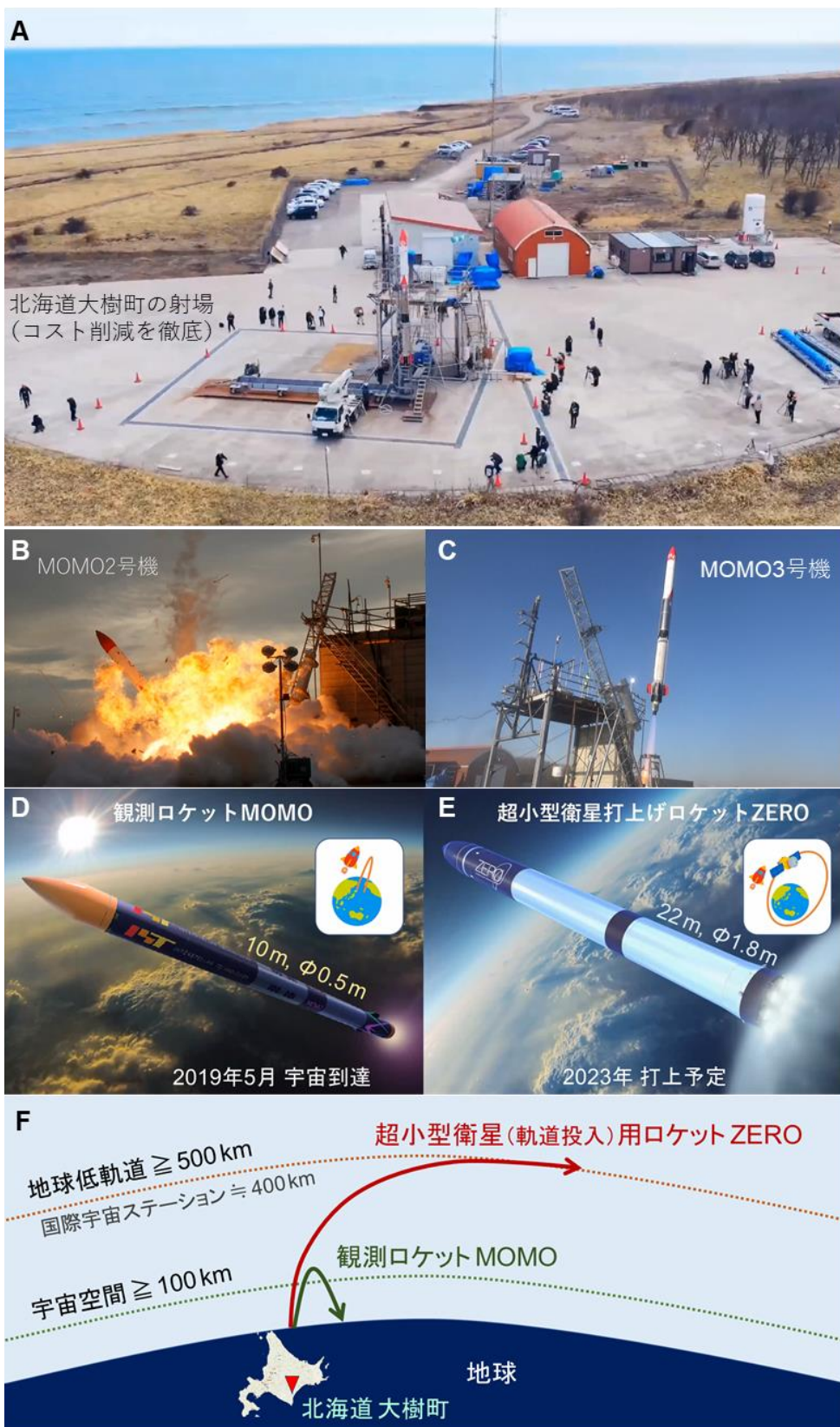
図 3. (A) インターステラテクノロジズ IST の射場, (B) 打ち上げ直後に落下炎上する MOMO2 号, (C, D) 宇宙空間に到達し、国内民間初の快挙となった MOMO3 号の打ち上げと飛行イメージ図, (E) 開発中の超小型衛星( \leq 100 kg) 打ち上げ用のロケット ZERO (36 t) は 2 段式で、燃料は液体天然ガス LNG、価格は約 6 億円以下を予定, (F) 観測ロケット MOMO 及び軌道投入ロケット ZERO の航跡。稲川さんのインターステラテクノロジズ(株)は 2019 年度 蔵前ベンチャー賞 を受賞。[画像提供: A~E, インターステラテクノロジズ]
