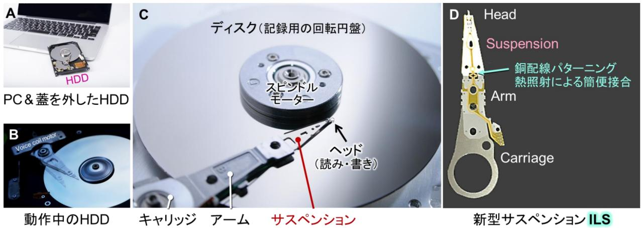
図 2. ハードディスクの大きさと構造(A), 動作の様子(B), 磁気記憶の読み・書き部の構造(C), 及び青柳さんたちが開発した新型サスペンション(ILS: integrated lead suspension)の特徴(D)。B: 高速回転するディスク(表面に磁性体を塗布した円盤=プラッタ)上をキャリッジ・アーム・サスペンションによって支えられたヘッドが Voice coil motor によって走査され、情報の読み書きがなされる様子を示す。C: ヘッドとディスクの間には薄い気流層が形成され、ナノメートル単位の隙間でヘッドはディスクから離れて機能するように設計されている。ディスクは Spindle motor によって駆動される。D: printed patterned suspension<sup>(注3)</sup>とも言う。出典: A~C, Photolibrary。
