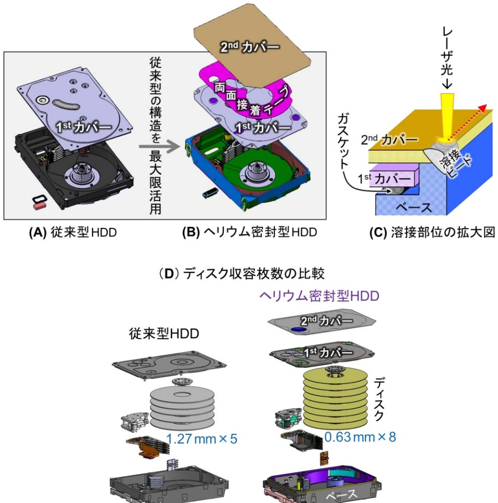
図 5. ヘリウム密封 (HelioSeal) 技術の概要。従来型 HDD の構造 (A) をできるだけ活用し、設備投資負担の軽減を図るとともに、2<sup>nd</sup> カバー (B) の材質とレーザ溶接法 (C) を工夫することにより、ヘリウムの密封に成功した。この間に、IBM の HDD 部門は日立に買収されたが、この買収は青柳さんたちのプロジェクトには“吉”と出た;なぜならば、レーザ溶接の位置決め問題解決の糸口は日立のレーザ溶接専門家のアドバイスから得られたからだ。合併後は元の所属にこだわらないようにしよう。◆ハードディスクにはプラッタというデータを記録する円盤(ディスク)が入っている。これに磁気ヘッドを使ってデータを記録・保存する。ヘリウムガスで内部を充填することによって、回転時の振動と抵抗が激減し、磁気ヘッドの精度向上とプラッタの厚さの削減が可能になった上に、20%近い省エネをも実現した。◆プラッタが薄くなっこことで、これまで 3.5 インチのハードディスク内に 5 枚までしか入らなかったプラッタを 8 枚も入れることが出来るようになっている (D)。
