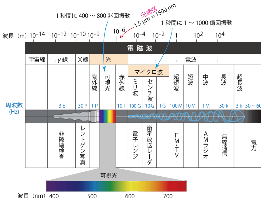
図1. 電磁波のスペクトル。光通信に使われている光は赤外線（波長 1.55 \mu\text{m} , 193.1 \text{ THz} ）で目には見えない。光ファイバの中は明るく輝いているように思うが、実は暗いのだ。M (mega) 10^6 , G (giga) 10^9 , T (tera) 10^{12} , P (peta) 10^{15} , E (exa) 10^{18} .
