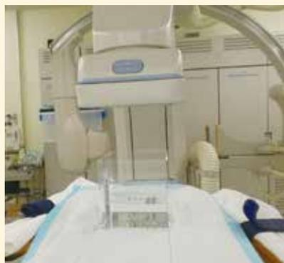
図2 開発したアブレーションカテーテル電極用材料のX線透視下での視認性評価の様子（筑波記念病院放射線科協力）
