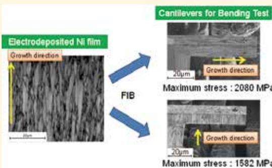
図 3. 柱状結晶粒を有する Ni めっき皮膜から結晶成長軸に平行/垂直方向に切り出した片持梁試験片とその曲げ強度
