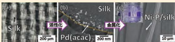
図 1 (a) 処理する前のシルク基材, (b) Pd(acac)<sub>2</sub> 触媒で活性化されたシルク基材, (c) Ni-P 薄膜 / シルク複合材料
