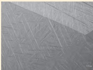
図1 生体用β型Ti-Zr-Nb合金中に成長したウイドマンステッテン組織。幾何学的な組織が美しい
