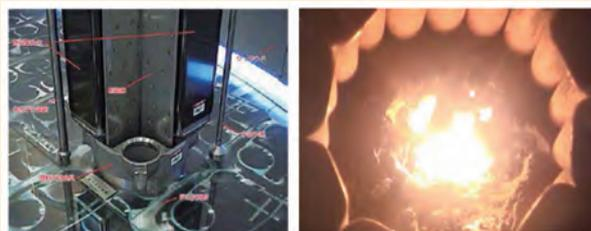
図3 原子炉芯構造物とコールドクルーシブルによるデブリ模擬熔融試験
