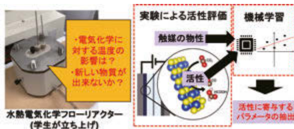
図3 (左) 学生が立ち上げた水熱電気化学フローリアクター (右) 機械学習を用いた活性パラメータの抽出
