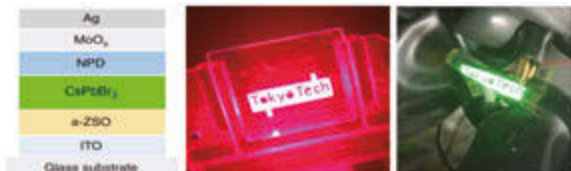
図2. アモルファスZn-Si-O (ZSO) の新たな電荷輸送層を用いるペロブスカイトELの素子構造および発光写真。右図はプラスチック基板上に作製されたペロブスカイトEL。
