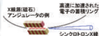
図1 高速に運動している電子を磁石により蛇行させるとその接線方向に発生する高輝度 X 線(シンクロトロン X 線) が材料科学などに活用されています。
