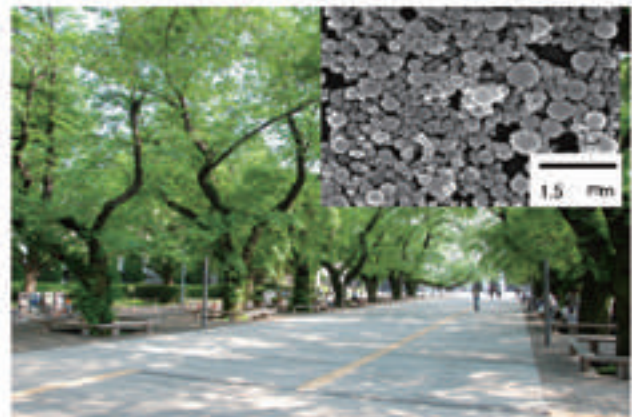
図1 ナノ粒子と特殊高分子系分散剤の利用による超高強度セメント系材料の使用例（東大本館前のデッキ；超高層建築物や羽田空港滑走路などに実用されています）
