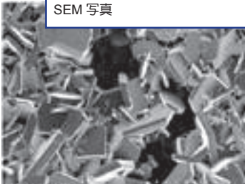
その場粒成長炭化ケイ素 (SiC) 多孔体の微構造 SEM 写真
