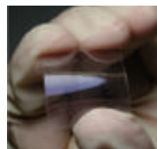
図1 IGZOを使った透明フレキシブルトランジスタ
