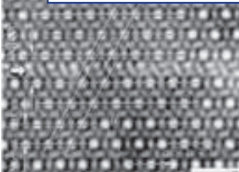
その場粒成長炭化ケイ素 (SiC) 多孔体の微構造 SEM 写真
