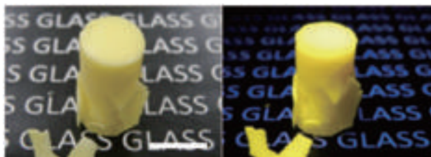
図 ソル-ゲル法によって作製した蛍光体分散シリカガラス。右は青色 LED を露光したもの。厚さや濃度を変えることで白色を得ることに成功。
