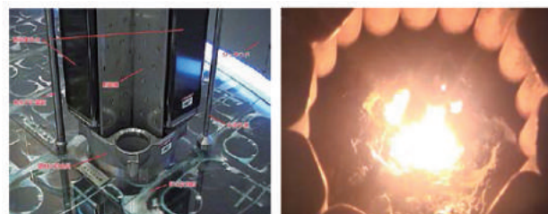
図3 原子炉炉芯構造物とコールドクルーシブルによるデブリ模擬溶融試験
