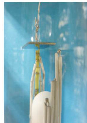
図2 霧気制御型高温酸化皮膜表面酸素ポテンシャル測定装置。高温ガス環境下における金属材料表面に形成する酸化皮膜表面の酸素の状態を観測する装置。酸化現象の本質に迫ります。
