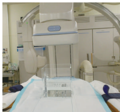
図2 開発したアブレーションカテーテル電極用材料のX線透視下での視認性評価の様子（筑波記念病院放射線科協力）
