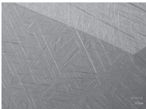
図1 生体用β型Ti-Zr-Nb合金中に成長したウィドマンステッテン組織。幾何学的な組織が美しい
