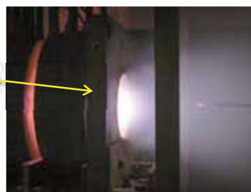
磁気ノズルから噴出される超音速膨張アークジェット
