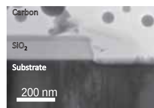
図5 デジタルエッチングされたAlGaIn層の断面TEM像とその模式図
