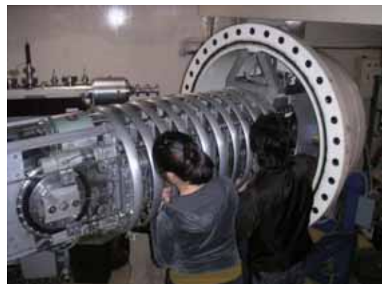
メンテナンス中の1.6メガボルト 静電イオン加速器
