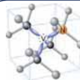
←図3. ダイヤモンド中の窒素空孔(NV)センタ
