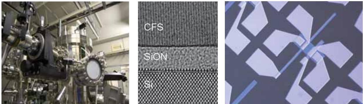
図2(a) 超高真空マルチチャンバー成膜装置, (b) 作製したホイスラー合金トンネル接合, (c) 磁気伝導評価デバイス.
