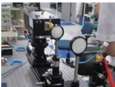
図5 HEMT受信器を用いた無線通信測定系
