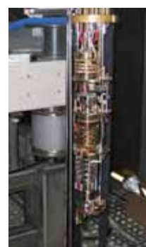
100mK以下の極低温を発生する希釈冷凍機(最低温部)
