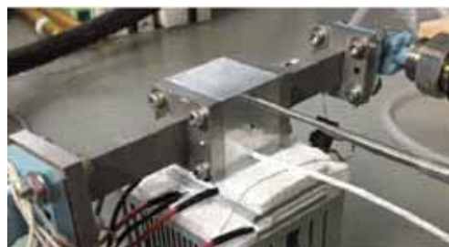
図1 導波管貫通法の温度可変測定系
