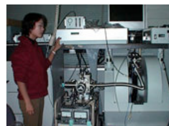
活性酸素の作る磁化の検出。レーザーとパルスEPRを組み合わせた装置による実験。
