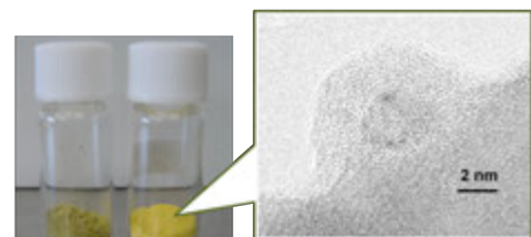
光触媒粉末 (100 nm ~ 1 μm)
